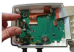
Sujete el módulo de comunicación inalámbrica con los dedos tal como se indica en la imagen y deslícelo entre los dos soportes.
