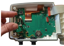
如图, 将无线通讯模块 插入到支架中
