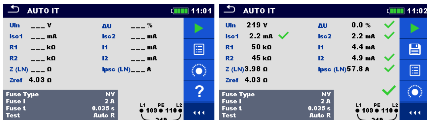
Fig. 4.117: Exempel på AUTO IT mätresultat
