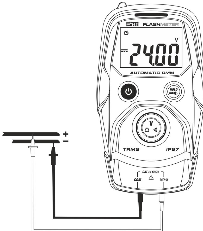
Abb. 3: Verwendung des Gerätes für Gleichspannungsmessung
