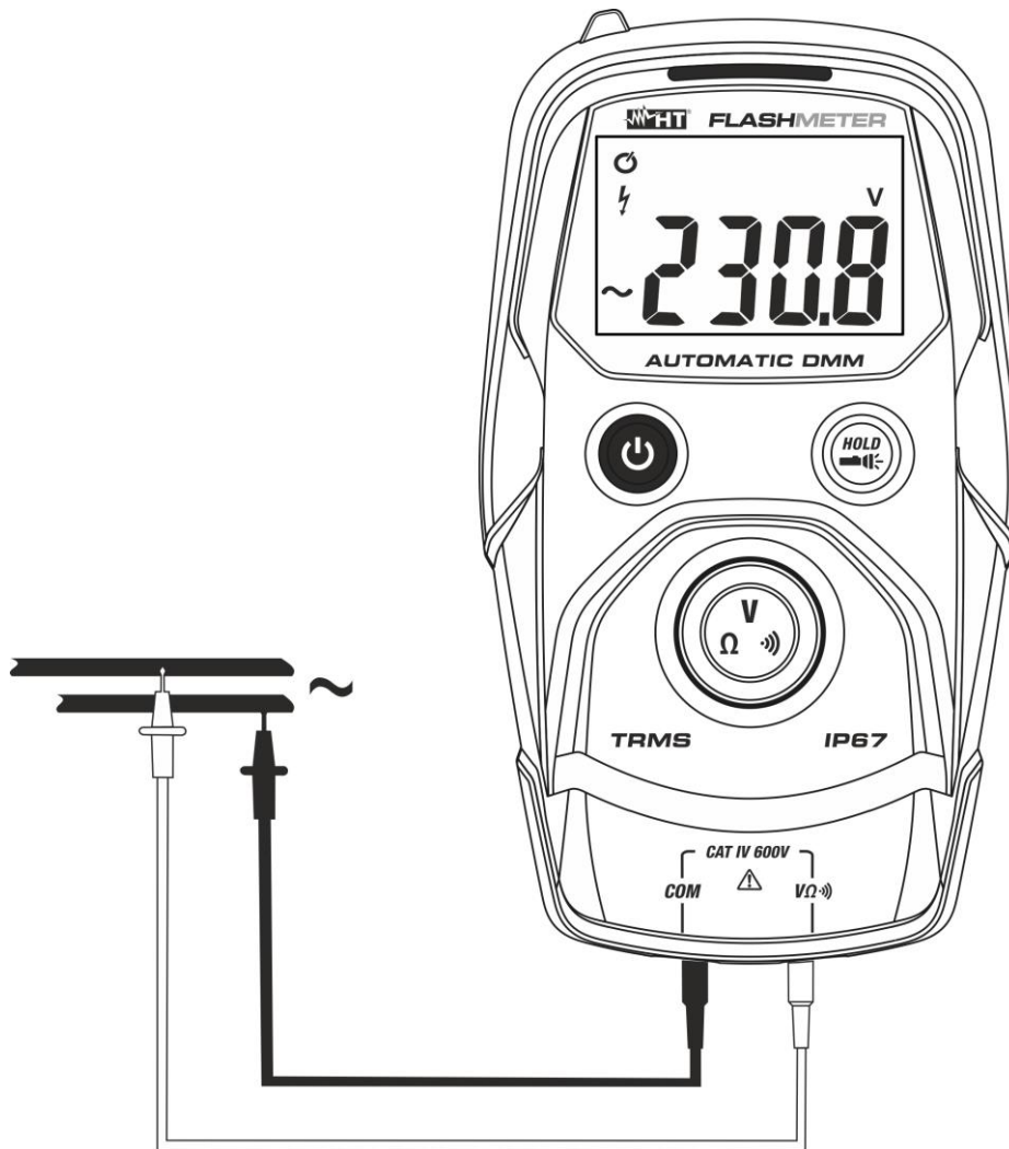
Fig. 4: Utilisation de l'instrument pour la mesure de la Tension CA
