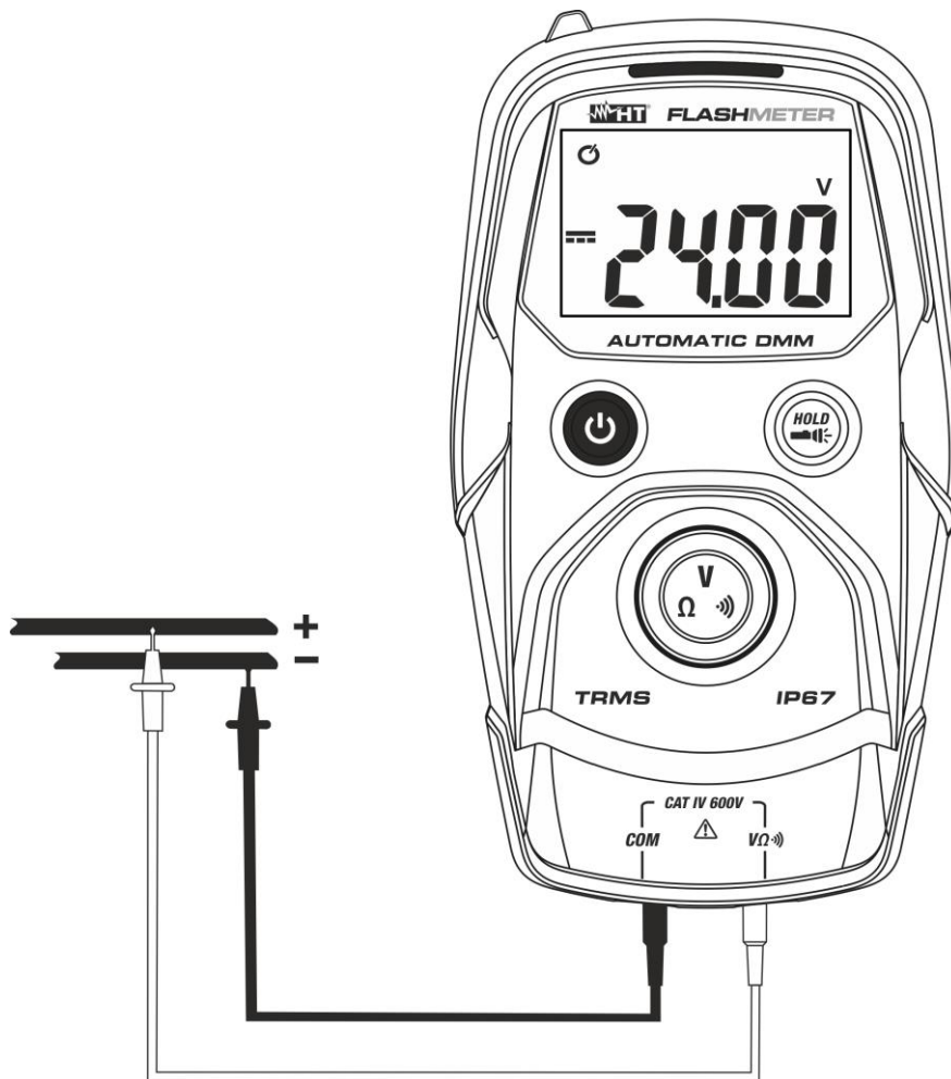
Fig. 3: Uso dello strumento per misura di Tensione DC
