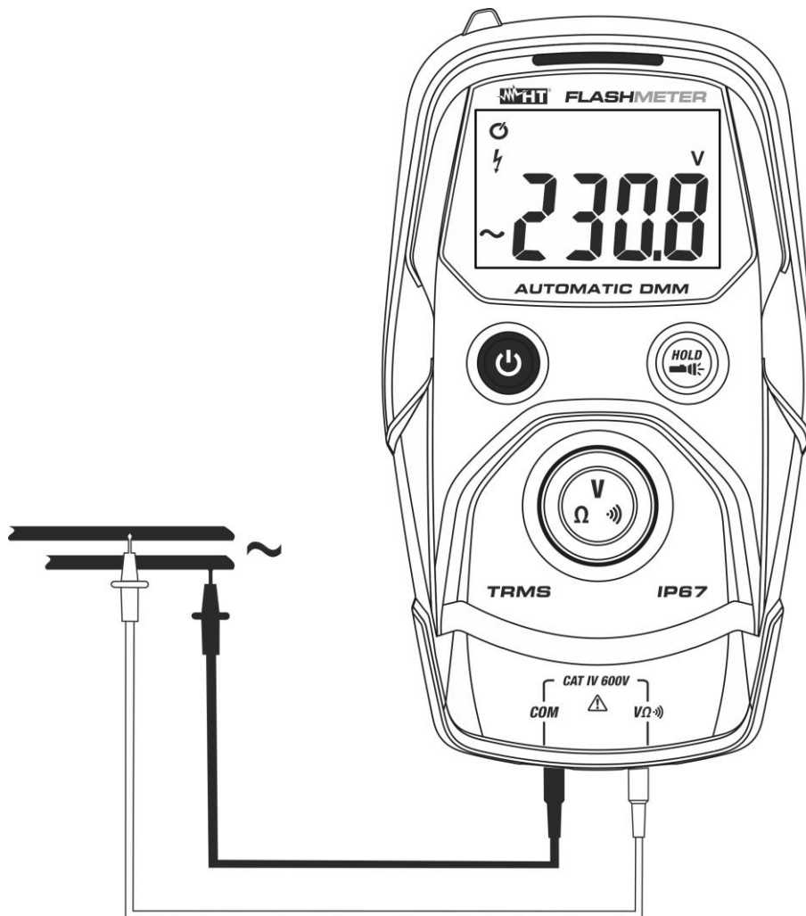
Abb. 4: Verwendung des Gerätes für Wechselspannungsmessung
