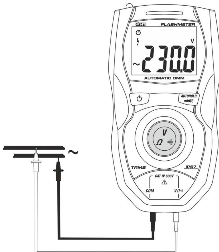
FIG. 4: Användning av instrumentet för växelströmsmätning
