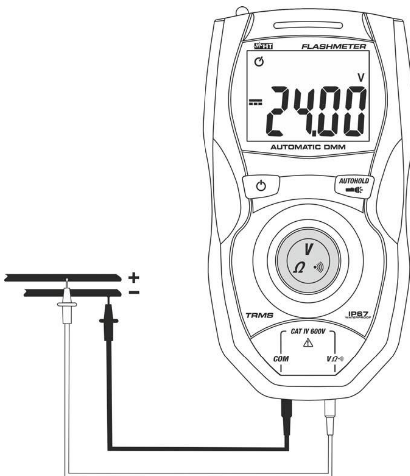
FIG. 3: Användning av instrumentet för likspänningsmätning
