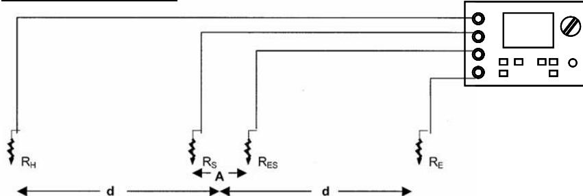
Der spezifische Bodenwiderstand wird beim Schlumberger-Verfahren durch folgende Formel berechnet:
