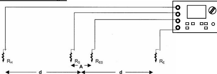
La resistividad del suelo se calcula, según el método de Schlumberger, mediante la fórmula:
