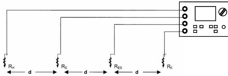
Der spezifische Bodenwiderstand wird beim Wenner-Verfahren durch folgende Formel berechnet:
